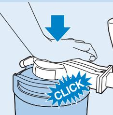
**2** Inserite il rubinetto sulla parte superiore di collegamento del barile spingendolo con decisione finché non scatta in posizione.
