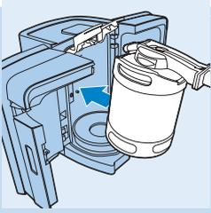
**3** Inclinate leggermente in avanti il barile con il rubinetto inserito e posizionate all'interno dell'apparecchio.
